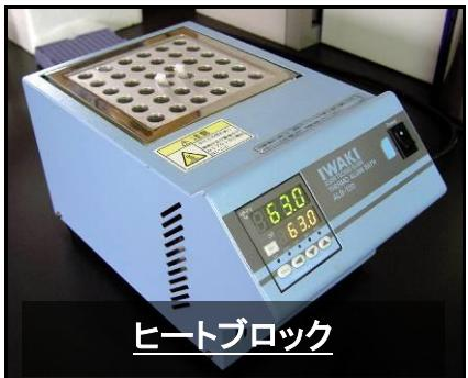
全てのキヤップを閉じた状態でタッピングあるいはボルテックスミキサーにて 1 秒間 × 3 回の攪拌にて混合した後、スピンドダウンを行い、ウォーターバス、ヒートブロック、サーマルサイクラー、エアーアインキュベーターなどを用いて 63°C で 60 分間保温します。
