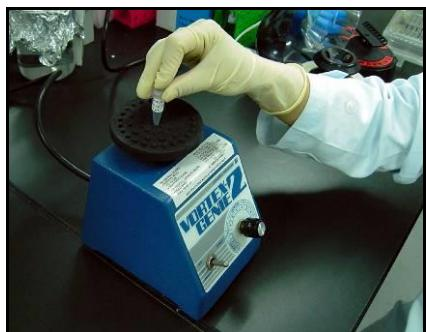
チューブの腹を指で数回軽く叩く（以下タッピング）あるいはボルテックスミキサーにて 1 秒間 × 3 回の攪拌により混合し均一にした後、簡易遠心機を用いて溶液をチューブの底に集め（以下スピンダウン）、試薬を氷上に静置します。
