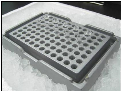
核酸の汚染がないピンセットを用いて検査用チューブを袋から取り出し、アルミブロックあるいはプレートラックに立て、検査溶液を 18.0  $\mu\text{l}$  ずつ分注します。
