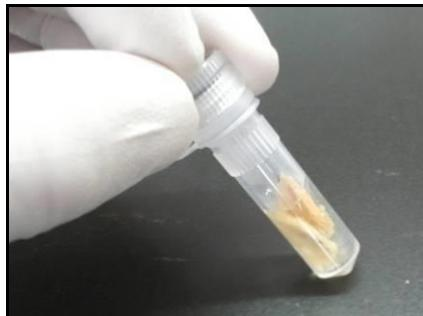
Bx 抽出液を取り出し、室温で完全に融解します。容器のキャップを閉じた状態で容器を 10 回上下に反転させて混合し、均一にした後、抽出用チューブに 800  $\mu\text{l}$  を分注します。次に、採取した円盤状（半円）のマツ材片 2 枚を、完全に Bx 抽出液に浸るように入れます。
