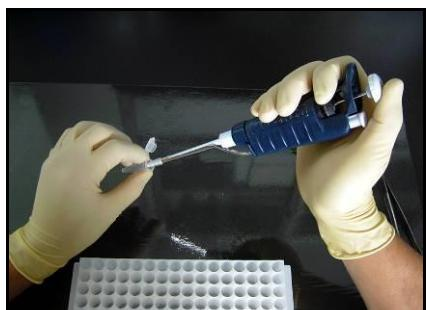
検査溶液調製用チューブ（1.5 ml あるいは 2.0 ml）に下記の試薬を必要テスト数分ずつ分注し、タッピングあるいはボルテックスミキサーにて 1 秒間 × 3 回の攪拌により混合した後、スピンダウンを行います。これを検査溶液とし、氷上に静置しておきます。
