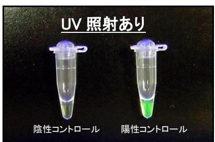
最初に、陽性コントロール検査溶液が蛍光を発色し、陰性コントロール検査溶液が蛍光を発色していないことを確認してください。これを満たしていない場合は検査結果を無効とし、原因を究明してください。
