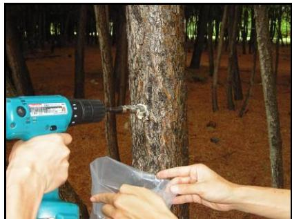
直径 15 mm の木工用ドリルを用いて対象とするマツ樹木からマツ材片を採取します。より正確な検査を行うために、樹木の高さ別に複数箇所からマツ材片を採取してください。
