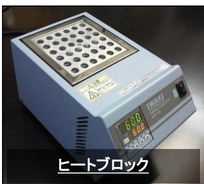
全てのキャップを閉じた状態でタッピングあるいはボルテックスミキサーにて 1 秒間 × 3 回の攪拌にて混合した後、スピンドウンを行い、サーマルサイクラー、インキュベーター、あるいはウォーターバスとフロートを用いて 60°C で 1 時間保温します。
