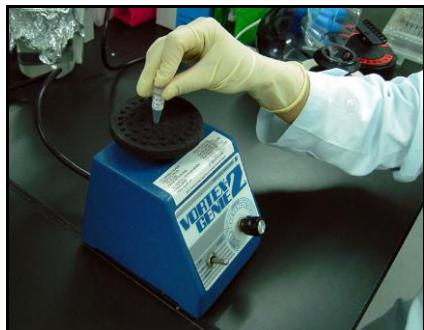
チューブを数回軽く叩く（以下タッピング）あるいはボルテックスミキサーにて 1 秒間 × 3 回の攪拌により混合し均一にした後、簡易遠心機を用いて溶液をチューブの底に集め（以下スピンダウン）、試薬を氷上に静置します。
