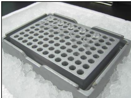
核酸の汚染がないピンセットを用いて検査用チューブを袋から取り出し、アルミブロックあるいはプレートラックに立て、磨碎サンプル 1 検体あたり 2 本の検査用チューブを用意し、Q 検査溶液、B/Q 検査溶液をそれぞれのチューブに 8.0  $\mu\text{l}$  ずつ分注します。
