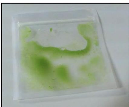
硬く滑らかな器具\*を用いてバッグの上から強く磨砕し、葉片を十分に磨砕して均一な状態にしてください。
