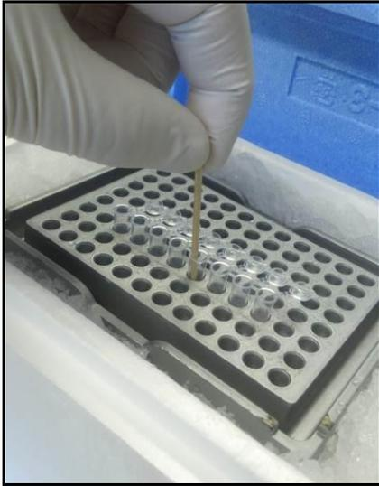
前工程で磨砕した葉サンプルを爪楊枝の先端に浸漬し、爪楊枝を検査溶液に浸して Loopamp 反应用チューブの底に軽くこすり付けます。その後、爪楊枝は速やかに取り出し、ビニール袋にまとめて廃棄します。サンプル添加後、キャップを閉じます。
