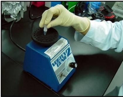
チューブの腹を指で数回軽く叩く（以下タッピング）あるいはボルテックスミキサーにて1秒間 x 3回の攪拌により混合し均一にした後、簡易遠心機を用いて溶液をチューブの底に集め（以下スピンドウン）、試薬を氷上に静置します。
