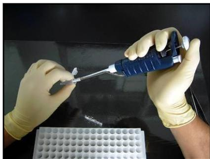
マイクロチューブ（1.5 ml あるいは 2.0 ml）に下記の試薬を必要テスト数分ずつ分注し、タッピングあるいはボルテックスミキサーにて 1 秒間 × 3 回の攪拌により混合した後、スピンドウンを行います。これを検査溶液とし、氷上に静置しておきます。
