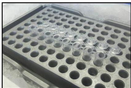
核酸の汚染がないピンセットを用いて Loopamp 反応用チューブを袋から取り出し、アルミブロックあるいはプレートラックに立て、検査溶液を 25.0  $\mu$ l ずつ分注します。
