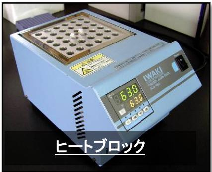
全てのキャップを閉じた状態でタッピングあるいはボルテックスミキサーにて 1 秒間 × 3 回の攪拌にて混合した後、スピンドダウンを行い、ウォーターバス、ヒートブロック、サーマルサイクラー、エアーアインキュベーターなどを用いて 64°C で 30 分間保温します。
