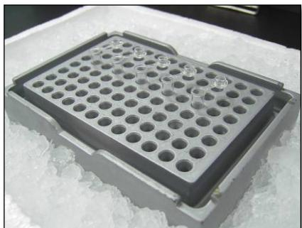
核酸の汚染がないピンセットを用いて検査用チューブを袋から取り出し、アルミブロックあるいはプレートラックに立て、検査溶液を  $16.0 \mu\text{l}$  ずつ分注します。
