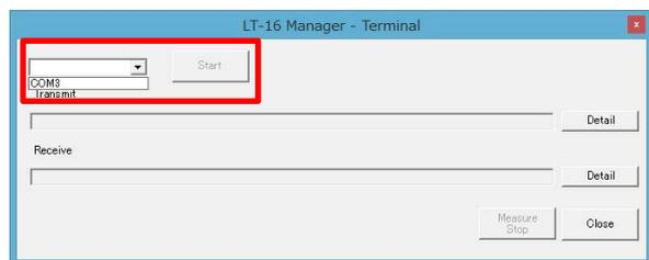
メインウィンドウから Read を選択した場合、左のウィンドウが表示されます。左上のプルダウンメニューから USB ポートを選択すると、Start が押せる状態に変化しますので、Start を押して読み込みを開始してください。
