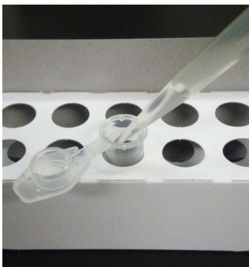
主に、試薬の混合に用います。左の図のようにペーパーチューブラックに 1.5 ml マイクロチューブを立てて、必要な試薬を分注します。
