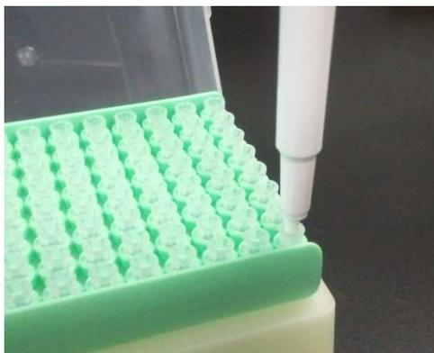
使用ごとに、マイクロピペットの先端にピペットチップを装着します。装着が不十分だと、液漏れやデータ精度の悪化の原因となりますのでしっかりと装着します。この際、ピペットチップの先端が破損しないように注意してください。
