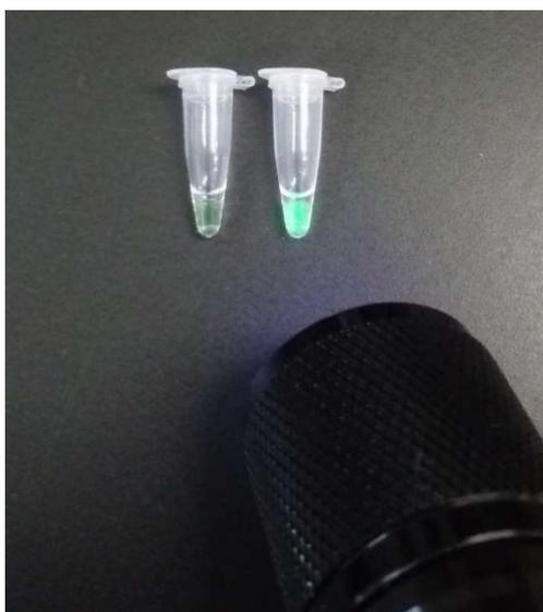
株式会社ニッポンジーンのキットは蛍光発色液による増幅判定を採用しています。蛍光発色液による判定を行う場合、反応終了後にUV-LEDランプを用いてUV（紫外線）を反応チューブに照射してください。
