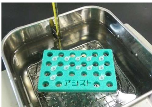
湯浴による保温、反応を行う場合、左の図のようにフロートプレートを浮かべてください。使用の際には、熱湯に十分ご注意ください。
