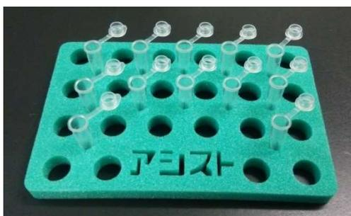
フロートプレートの穴は 1.5 ml マイクロチューブなどを差し込んで使用できるほか、小さな切り込みがありますので、反応用の小型チューブ (0.2 ml チューブ) のラックとしても使用できます。左の図のように、最大 12 本までチューブを立てることができます。チューブを深く差せば、フロート (浮き) として使用できます。
